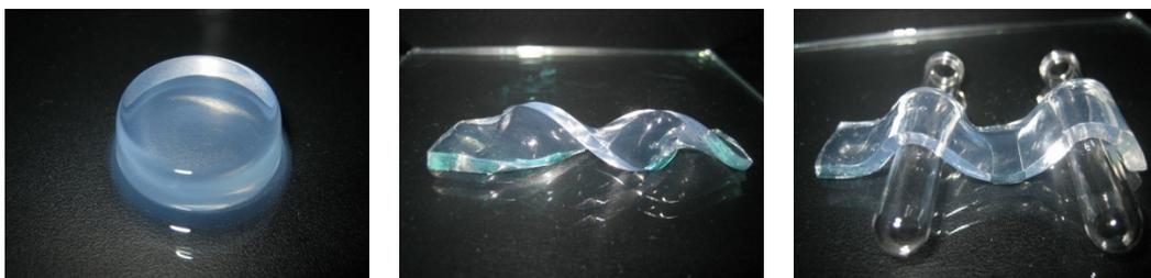
これは、2種類の水溶液を混合し室温で放置するだけで、水溶性成分が3次元ネットワークを形成してゲル化するものです。これら水溶液に添加物を加えることで、お客様のニーズに合わせた処方や成形が可能です。
